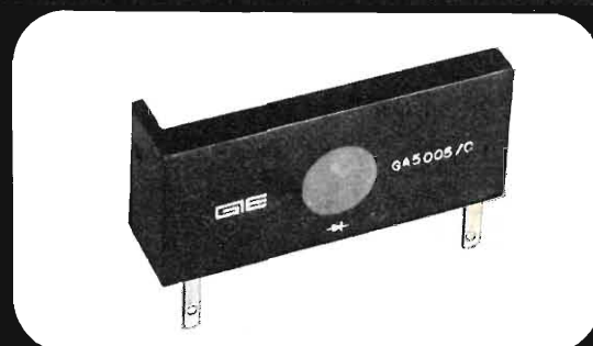
Diodi Damper - GA 5005 B (300 mA, 6000 V. per TV B/N e GA 5005 C (440 mA, 7000 V.) per TV colore.
