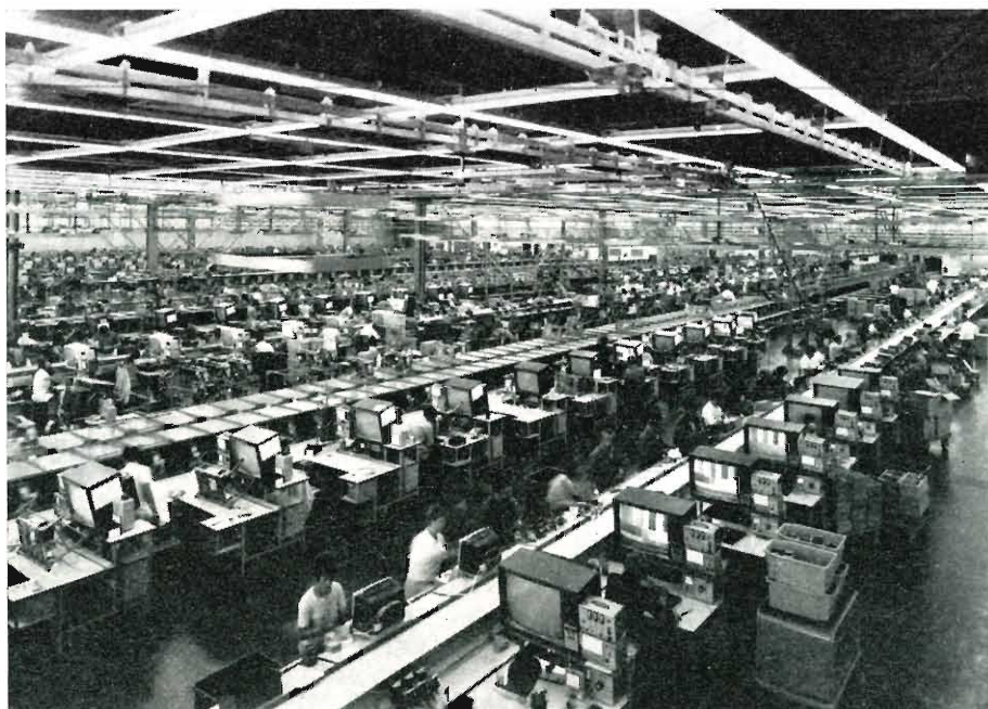
Un reparto della catena di montaggio di TV a colori Grundig di Langwasser - Norimberga (Foto, Grundig).
